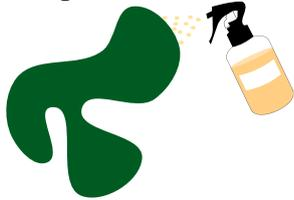
Behandeln Sie verschmutzte Stellen mit der Gebrauchslösung. Streichen Sie die Lösung z.B. mit einem Pinsel oder einer Bürste auf die Stellen oder besprühen Sie diese, z.B. mit einer Sprühflasche.
