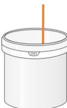
Mit dem Bohrmaschinen Rührer 120 solange rühren, bis Kiesel / Quarz gleichmäßig benetzt sind (Körner sehen nass aus). Besonders **Rand- und Bodenbereiche** beachten!
