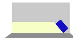
Eine Teilmenge (ca. 250 bis 300g) des Bindemittels entnehmen. Mit einer Kunststoffspachtel lückenlos auf der Fläche verteilen. Grundierung nicht aushärten lassen, sondern sofort weiterarbeiten.
