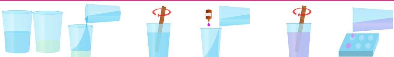
Bei Teilmischungen: Harz und Härter genau in separate Behälter einwiegen.
