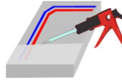
2K Polyurethan Cast Resin auf die einzuziehenden Bauteile auftragen und aushärten lassen.
